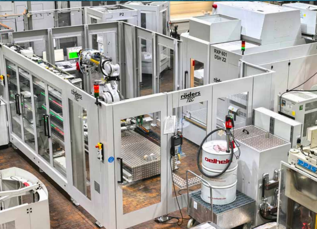
自动化：右上角是带双主轴的RXP 601 DSH Z2铣削中心；中间是机器人；左边是存放工件和刀具的物料库（照片：Klaus Vollrath）
