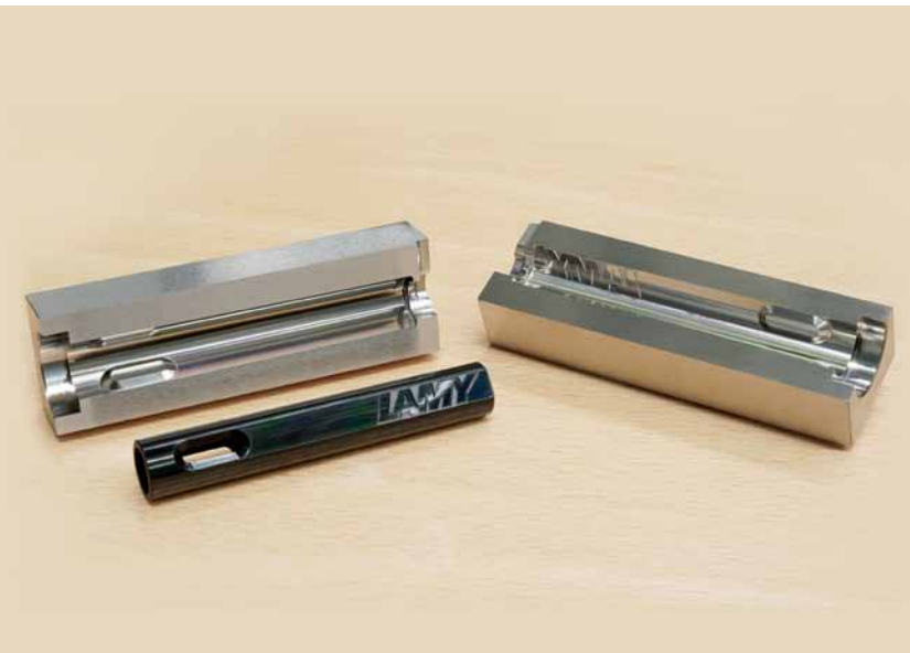
醒目而独特：钢笔笔杆上的Lamy标识以及经过铣削、未涂层的模具镶件 （图片来源：罗德斯）
