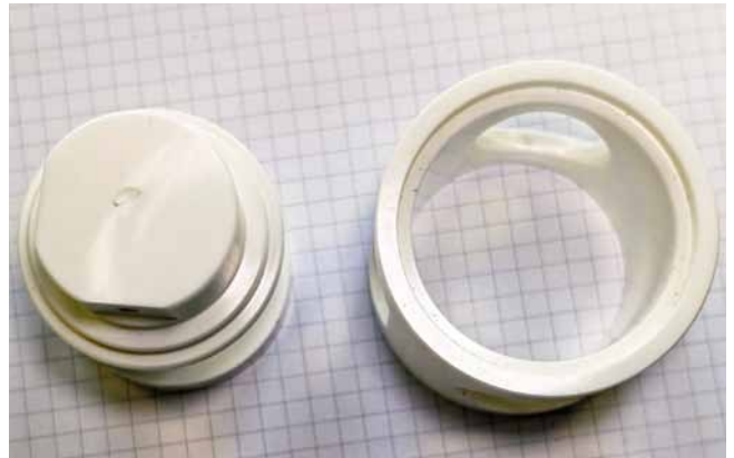
用于处理低温液化气体的转子和壳体必须以微米级精度进行加工。（照片：Klaus Vollrath）
