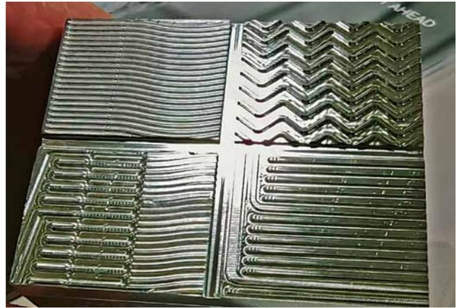
样品工件（50毫米 x 40毫米），具有双极板典型的各种表面结构，由Böhler K888 Matrix材料制成，硬度为63+1 HRC（照片：Klaus Vollrath）。
