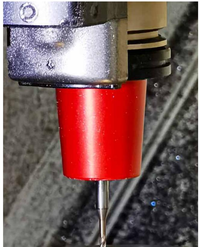
MHT介质分配器的空心套筒在不接触或不随工具夹头旋转的情况下包围了工具夹头。空气和润滑剂通过位于主轴下方的对接接口供应（Photo: Klaus Vollrath）
