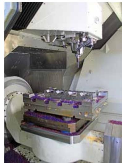
Beim Blick in den Arbeitsraum fallen die robuste, durch Führungen an allen vier Ecken besonders steife Z-Achse sowie der stabile, zweiseitig gelagerte Dreh-Schwenktisch ins Auge (Foto: Klaus Vollrath)
