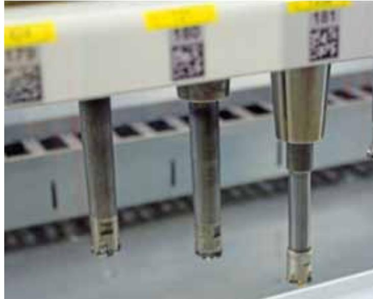
Die Spindeln bearbeiten das auf 50 HRC gehärtete Material mit Messerköpfen bis zu 35 mm Ø (Foto: Klaus Vollrath)
