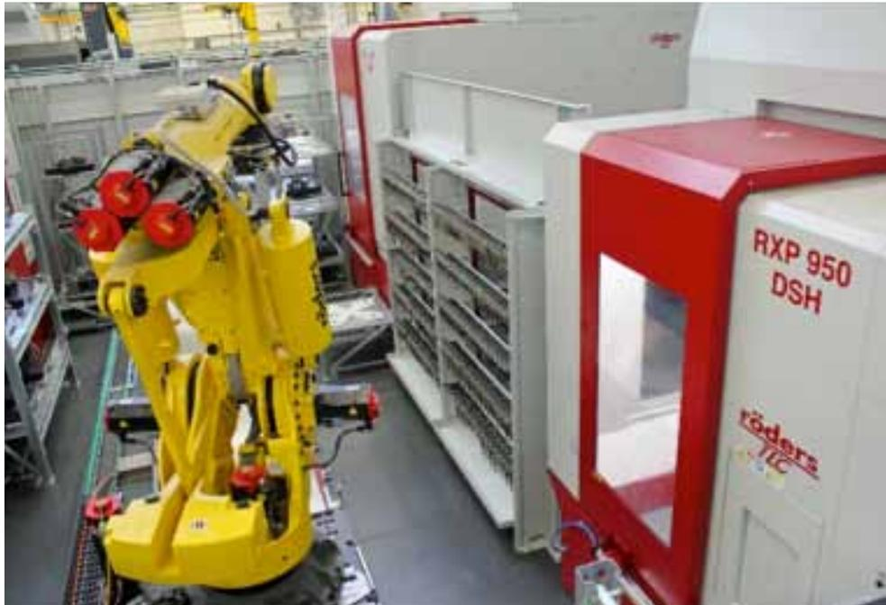
Aktueller Stand der vollautomatisierten Fertigungszelle mit zwei Fräsbearbeitungszentren RXU 1200 DSH, einer Anlage RXP 950 DSH sowie einem Roboter mit einem Brutto-Tragvermögen von 790 kg und einem großen Speicher für Fräswerkzeuge und Paletten (Foto: Klaus Vollrath)
